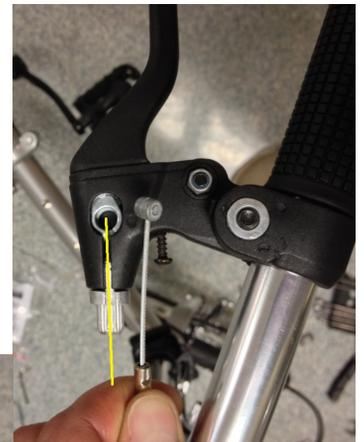
Ziehen Sie auch entsprechend den Handbremsgriff für die Rückbremse auf der rechten Seite des Lenkers fest.
