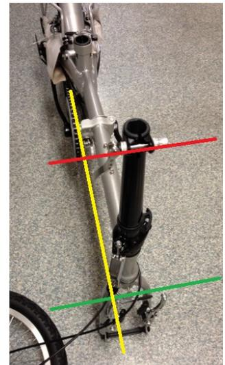
Drücken Sie die Lenkachse etwas runter, ohne den Winkel zu verändern, und drehen Sie die Innensechskantschraube mit dem mitgelieferten Insechskantschlüssel.
