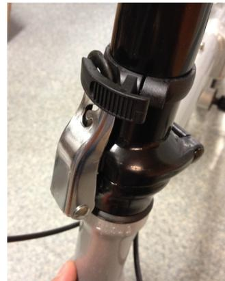
Montieren Sie Sattel und Lenker, spannen Sie mit den Feststellhebeln.
