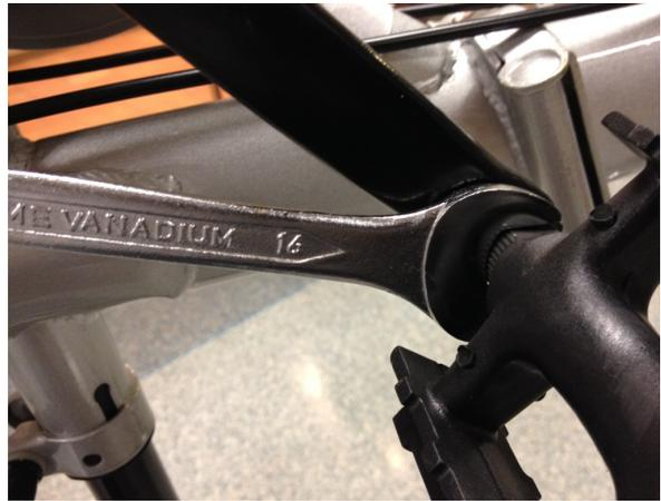
**ACHTUNG:** Nicht überdrehen. Die Tretkurbel ist aus Aluminium und die Gewinde können bei Überlastung beschädigt werden.
