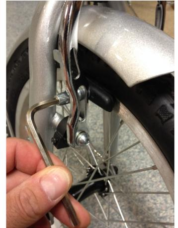
Schrauben Sie das vordere Schutzblech fest. Befestigen Sie den Reflektor an der Schutzblechschaube an der Vorderseite der Gabel. Schrauben Sie die Klingel am Lenker an. Pumpen Sie die Reifen auf. Das Fahrrad ist nun fertig montiert und fahrbereit.
