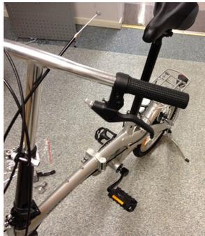
Drehen Sie die äußeren Stellschrauben so, dass der Ausgang für den Bowdenzug nach unten zeigt (gelbe Linie). Legen Sie den Bowdenzug ein und ziehen Sie die äußeren Stellschrauben an. Ziehen Sie den Bremsgriff zurück, spannen Sie den Bowdenzug und ziehen Sie den Bremsgriff mit dem mitgelieferten Inbusschlüssel fest.
